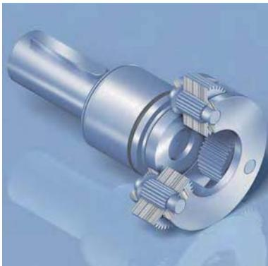
行星臂架与输出轴采用一体式的结构，且行星齿轮采用两端支撑的方式设计，可确保最大的扭转刚性和输出负载能力。
